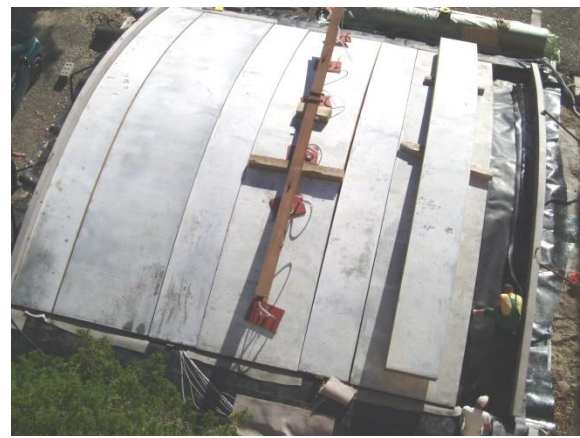
Bild 8: Heißwasser-Erdbecken-Wärmespeicher mit freitragender Abdeckung, Tonnendach aus Hochleistungsbeton-Sandwichelementen, Außenlabor-Forschungsspeicher am ITW
