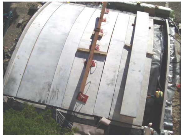
Bild 6: Heißwasser-Erdbecken-Wärmespeicher mit freitragender Abdeckung, Tonnendach aus Hochleistungsbeton-Sandwichelementen, Außenlabor-Forschungsspeicher am ITW
