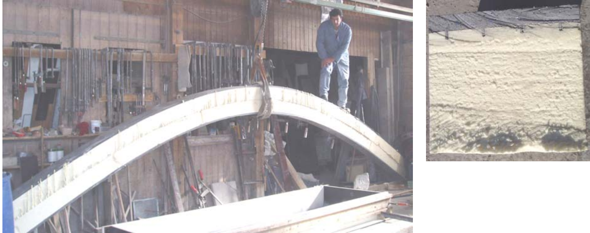
Bild 2: Prototyp des Sandwich Fertigteils, gefertigt aus 2 Teilen mit je 2 cm HL-Beton und 16 cm PUR-Dämmung
