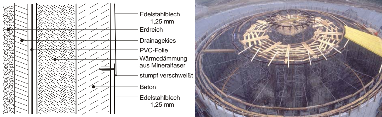
Bild 7: Aufbau der Speicherwand und Speicher im Bau (Projekt Friedrichshafen)
